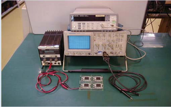
图 1: 评估频率匹配所需测试仪器基本组成
